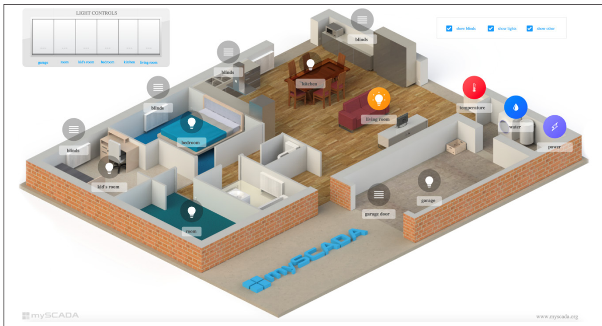
Рис. 6. Приклад інтерфейсу myScada для управління Z-Wave-пристроями за допомогою специфікації OPC UA
