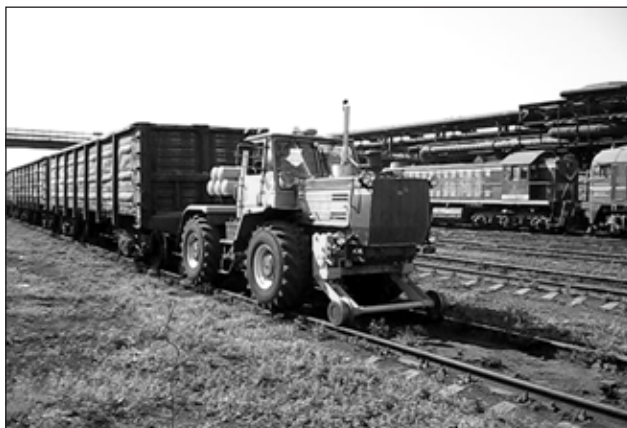
Рис. 1. Маневровый тягач ТМ1.175 во время испытаний на путях металлургического предприятия
